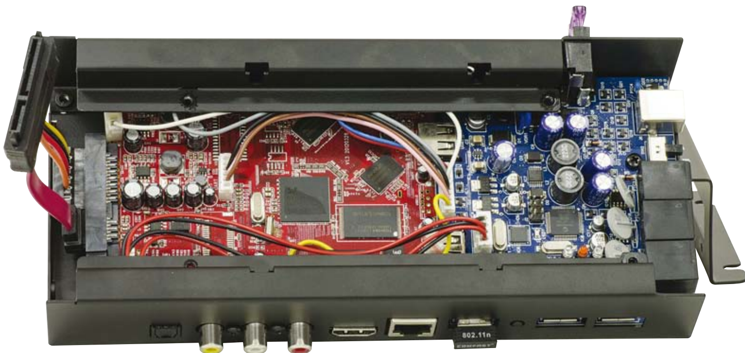
Rimosso anche il secondo pannello accediamo alla parte più interna dove troviamo le due schede di cui è composto il "bit Play HD". La prima rappresenta il player vero e proprio, la seconda governa le funzionalità principali, oltre alle interfacce e le connessioni verso i dispositivi Audison.
