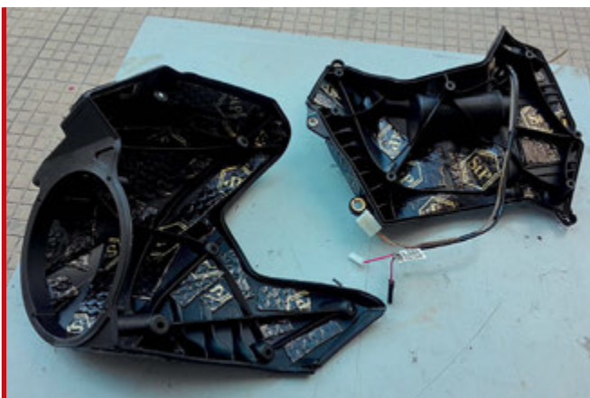
Tutte le parti in plastica sono state trattate con del materiale insonorizzante della STP.
