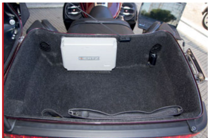
Nel bauletto posteriore, anzi nel "Tour Pack", è stato inserito l'amplificatore della linea Marine della Hertz, 8 canali con DSP integrato. Una soluzione che occupa uno spazio estremamente limitato.
