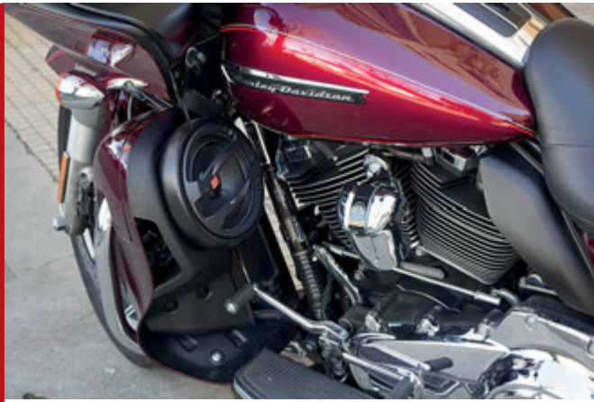
Non fatevi distrarre dallo splendido "107", il motore V-Twin di questa Road Glide Ultra: l'installazione del woofer Hertz SPL Show, effettuata attraverso l'interposizione di un anello sagomato, è altrettanto spettacolare.
