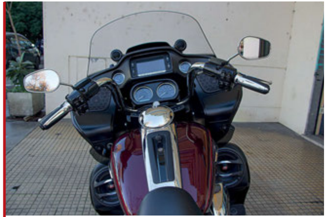
No, non è "storta" la foto. L'Harley è sul cavalletto laterale ed è naturalmente inclinata. Si può apprezzare il posto di guida con i tweeter ed i woofer superiori installati dietro la griglia.
