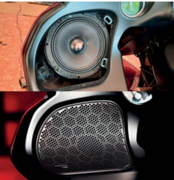
Il woofer superiore è inserito all'interno di un guscio che offre un piccolo volume di caricamento.
