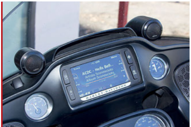
La struttura dei tweeter è particolarmente curata. Una struttura che nasce dalle contemporanee esigenze di contenere il "corpo" ingombrante del tweeter a compressione, di direzionare l'emissione verso l'anteriore e di fissare l'insieme in maniera estremamente solida e sicura su una struttura ricchissima di vibrazioni.
