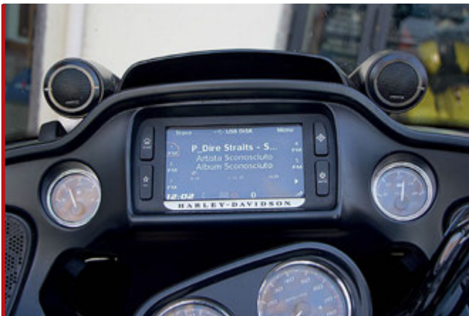
La sorgente di serie è stata mantenuta in virtù della sua integrazione con le funzioni di bordo, prime fra tutte la gestione dell'interfono, ma è stata sfruttata al meglio grazie al DSP Hertz.
