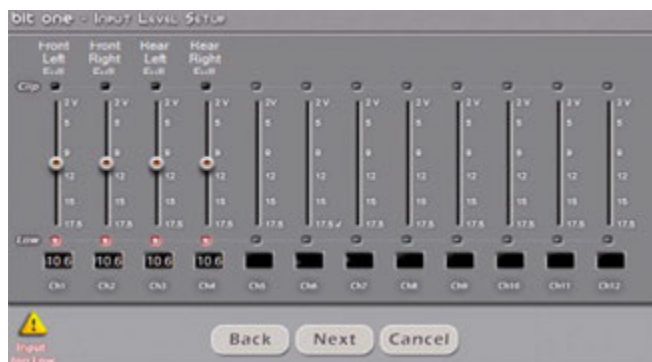
Dopo la procedura automatica di regolazione dei livelli d'ingresso, ecco il risultato ottenuto. Queste impostazioni sono successivamente disponibili dalla schermata principale.
