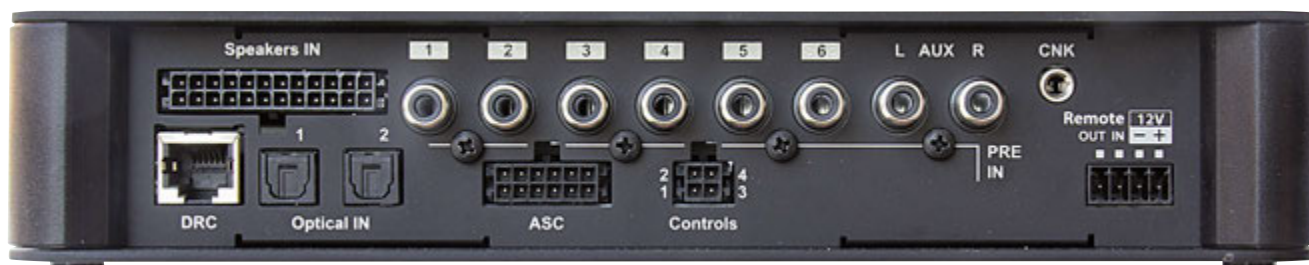
Il pannello degli ingressi mostra le diverse possibilità di interfacciamento della sorgente con i sistemi di serie, con sorgenti aftermarket e dispositivi ausiliari. In più si possono sfruttare i due ingressi digitali ottici per segnali provenienti da sorgenti integrate (magari con interfaccia MOST) e sorgenti HD, magari proprio un bit Play HD di Audison.
