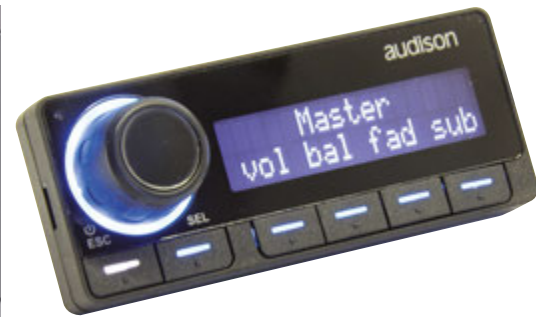
Durante le procedure di configurazione e taratura fatte con il PC, il DRC viene posto in stand-by. Diviene importante, anzi indispensabile, nell'uso quotidiano in auto, soprattutto se è presente anche un bit Play HD...
