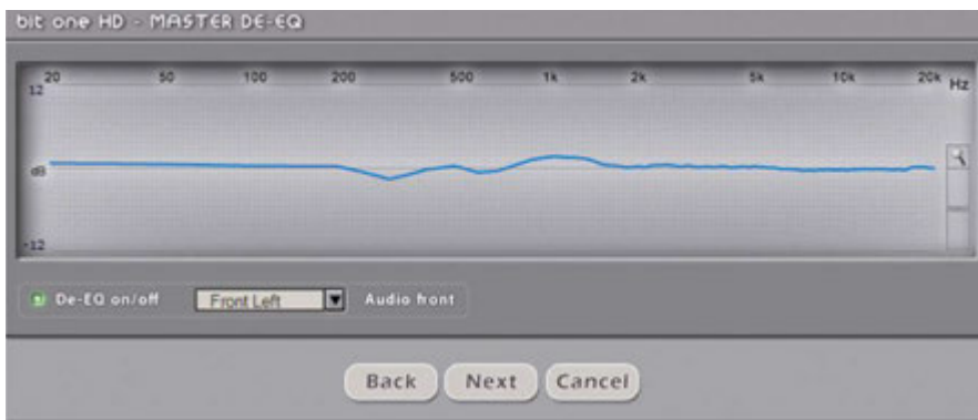
Il risultato di una simulazione di de-equalizzazione effettuata per mostrare la procedura. Il wizard, qui, si supera...
