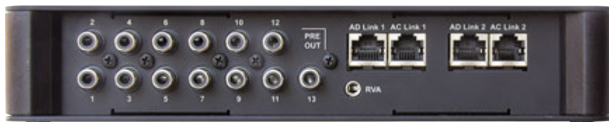
Sono ben 13 i possibili canali di uscita e ad ognuno di essi è dedicato un completo set di controlli, anche nel caso in cui si scelgano le uscite digitali "incapsulate" sul bus AD-Link.
