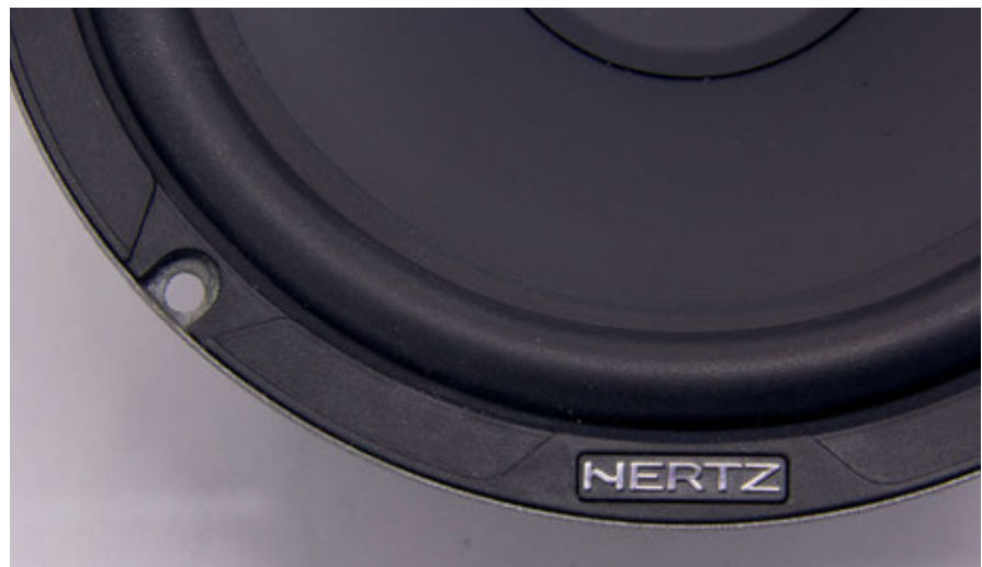
La cerniera del woofer è un particolare che merita attenzione. Il suo bordo, sagomato con precisione su diversi spessori per "incastrarsi" al meglio con la copertura della griglia, si estende per tutta la flangia, comprendendo anche i fori di fissaggio.
