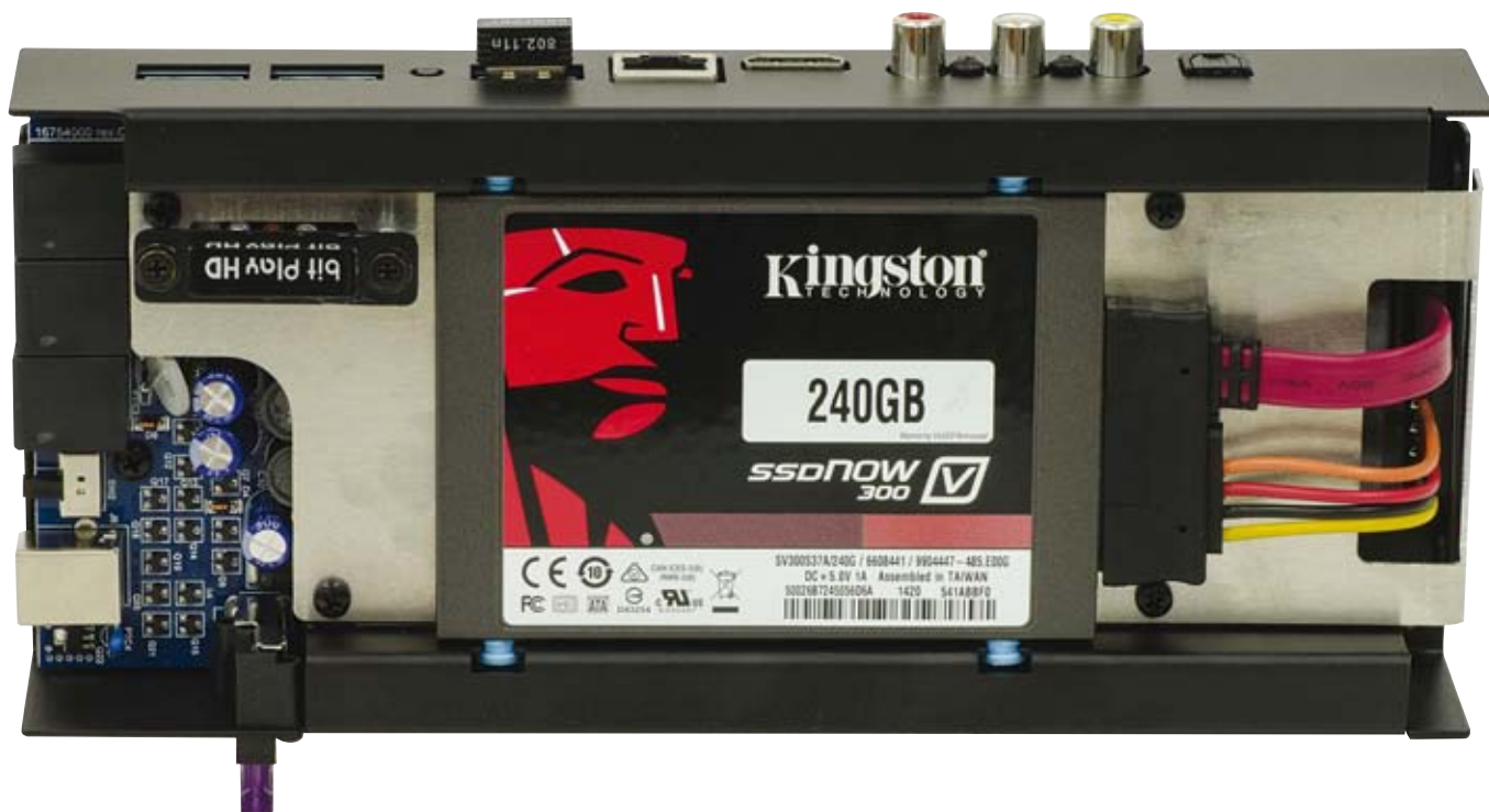
Rimosso il primo coperchio, si accede all'alloggiamento del disco rigido interno, qui occupato da un SSD da 240 Gbyte della Kingstone. Il "bit Play HD" accetta dischi fino a 2 TB ed è disponibile anche privo di disco interno.
