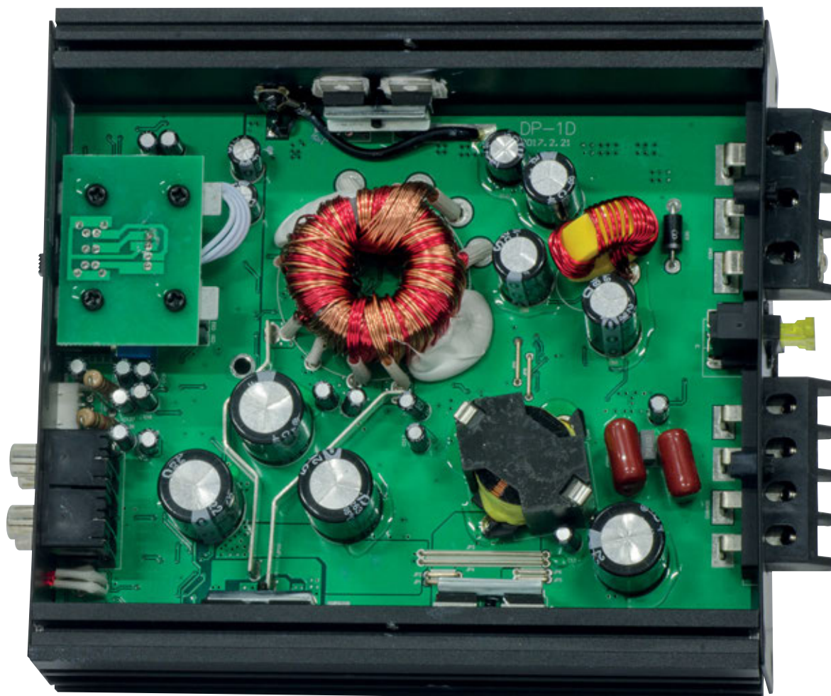
Rimossi i terminali laterali ed il pannellino di fondo, si accede alla faccia esterna della motherboard dove sono presenti, a dire il vero con un'asimmetria a cui non siamo troppo abituati, i componenti più ingombranti, dal toroidale di alimentazione ai condensatori fino al filtro LC di uscita tipico della Classe D. L'altra faccia, quella rivolta all'interno del telaio, ospita i componenti attivi.
