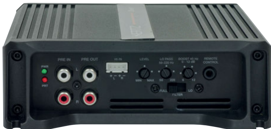
Il DPower 1 offre la possibilità di rilanciare il segnale rendendolo disponibile su due pin affiancati a quelli d'ingresso, anche se il segnale viene fornito attraverso il piccolo connettore tramite gli ingressi ad alto livello. Sullo stesso pannellino, le regolazioni e la piccola presa, a destra, per un controllo remoto di volume non fornito in dotazione.
