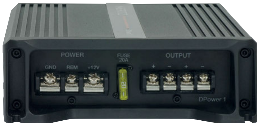
I morsetti di alimentazione prevedono, come di consueto, la connessione per l'accensione remota, tuttavia non necessaria se si sfrutta l'ingresso ad alto livello. Interessante notare lo sdoppiamento del morsetto per il segnale (monofonico) di uscita verso il subwoofer.
