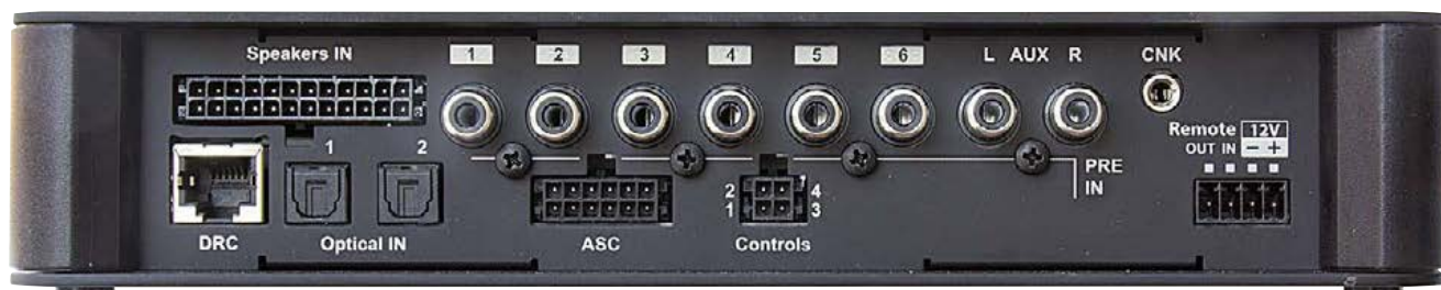
Il pannello degli ingressi. Oltre ai 6 canali pre e al multipolare con i 12 canali da connettere a segnali ad alto livello, troviamo i due ingressi digitali su S/PDIF in grado di accettare segnali fino a 192 kHz/24 bit, il connettore di alimentazione ed altri connettori per funzioni "speciali".
