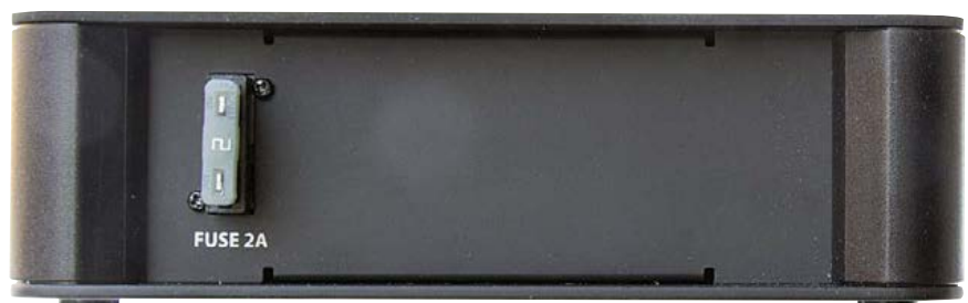
L'ultimo dei quattro pannellini è praticamente vuoto... C'è giusto il minuscolo fusibile da 2 ampère.
