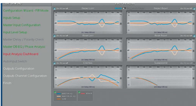
La schermata dell'Input Analysis. Per ognuno dei 6 gruppi (front Sx e Dx, rear Sx e Dx, sub e centrale) degli ingressi vengono mostrate le risposte in frequenza rilevate, la curva di correzione introdotta e la curva risultante.
