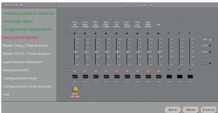
La schermata di setup dei livelli d'ingresso per un sistema con 9 canali.
