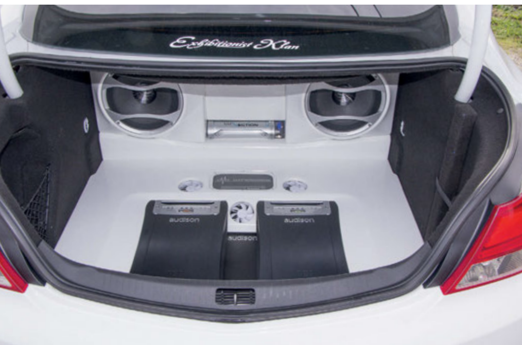
Il bagagliaio ospita elettroniche e subwoofer. I tre finali principali sono installati nel doppiofondo in cui sono presenti anche il processore, il bit Play HD e le due batterie da 6 volt. Anche il subwoofer, dai volumi separati per ognuno dei driver Audison TH 10 Basso, è integrato nella struttura.
