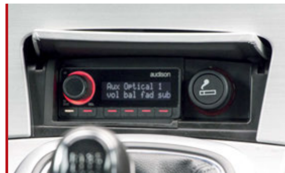
Il DRC del sistema, che controlla processore e player HD, è stato integrato nel vano posacenere ed è protetto da uno sportellino.
