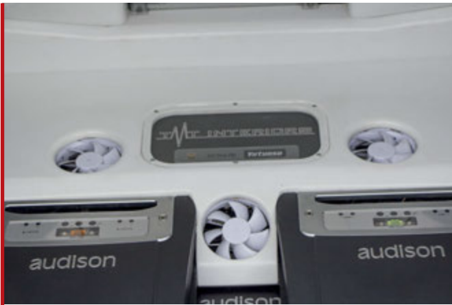
Tutta la zona dedicata alle elettroniche è aerata tramite ventole. Una "finestra" mostra il "cuore" dell'impianto, il processore Audison bit one HD Virtuoso.
