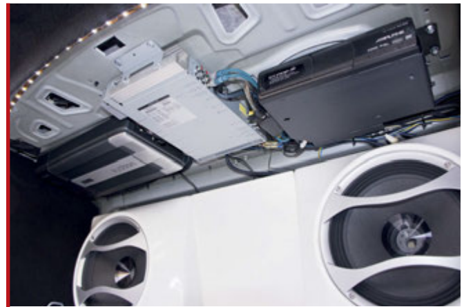
Il finale per i canali centrali e posteriori, l'elettronica di controllo ed il DVD Changer Alpine sono installati sotto la cappelliera.
