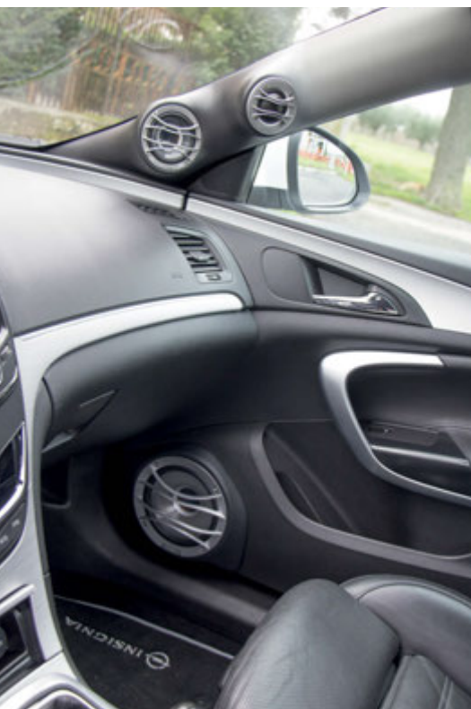
Un'inquadratura diversa del montante fa comprendere meglio la geometria dell'installazione del gruppo medio-alti.
