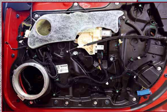
Der Mitteltöner erhält ein sehr aufwendiges GFK-Gehäuse, das sich perfekt an die Tür schmiegt
