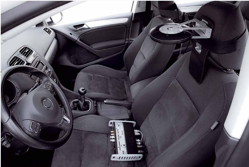
Der integrierte DSP der AP-Endstufen arbeitet auch mit Audisons Einmesssystem Bit Tune zusammen, wodurch Messen und Einstellen in einem Rutsch vor sich gehen
